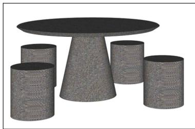
MESA REDONDA FEITA DE CONCRETO E IMPLANTADA NA FRENTE DOS LABORATÓRIOS 06 E 07 E ENTRE OS LABORATÓRIOS 06 E 08. EXECUTAR 3 MESAS.
