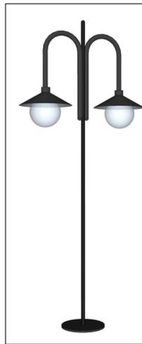
POSTE DE ILUMINAÇÃO QUE FICA NOS CANTEIROS ENTRE OS LABORATÓRIOS. UTILIZAR LÂMPADAS DE LED 3000K PARA PROPORCIONAR UMA ILUMINAÇÃO ACONCHEGANTE. ALTURA DO POSTE - POR VOLTA DE 290CM
