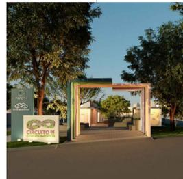
OBSERVAR QUE O TÔTEM DE IDENTIFICAÇÃO DA PLACA DO CIRCUITO SERÁ ILUMINADO COM LUMINÁRIA DE JARDIM APROPRIADA PARA RECEBER CHUVAS INTENSAS E UMIDADE. A TEMPERATURA DAS LÂMPADAS SERÁ DE 3000K
